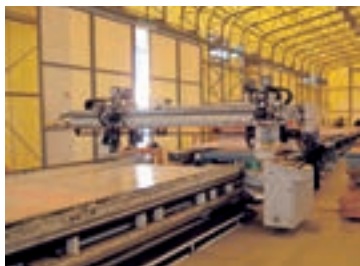
東金工場 パネル製造ライン（自動釘打ち機）
