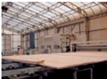
材木を枠材の形にカットするマルチカット装置
