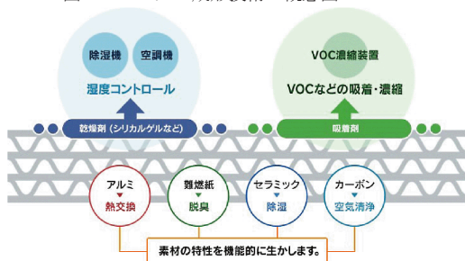
図1：ハニカム成形技術の概念図
