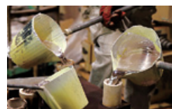
砂型へのアルミニウム合金の鋳込み
