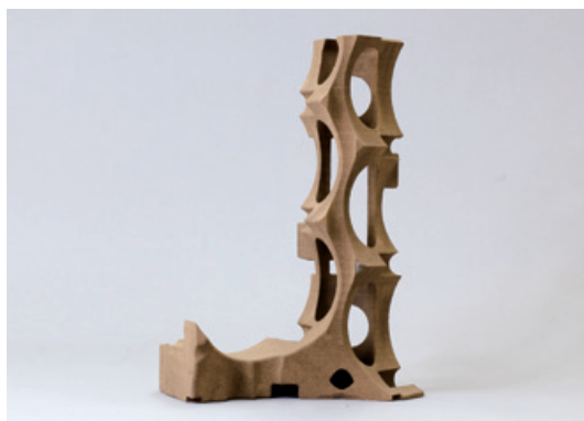
3Dプリンターで作製した鋳造用の砂型
