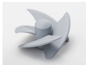
④インクジェット方式で作製した造形品
