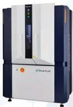
アスベスト(石綿)を使用した高度成長期の建物が耐用年数を迎えつつあります。その解体時のアスベスト含有調査に当社グループの製品が活躍しています。全自動多目的X線回折装置SmartLab SEは、特別な前処理を行うことなく低含有率のアスベストを検出することが可能です。
